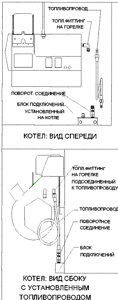
Схема 3I-1 - Установка блока подсоединений и масляной линии
